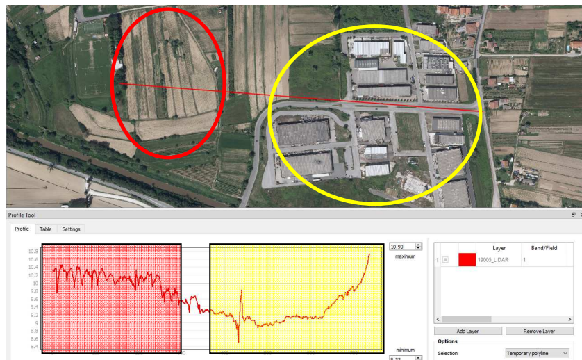
Figura 7.2 – Sezione trasversale nell'area in esame. In giallo l'urbanizzazione già realizzata, in rosso la zona in esame
