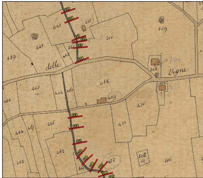
Figura 3.5 – Catasto leopoldino con indicazione del tracciato del Vallino di San Martino. Si evidenzia il tracciato con curve spigolose riscontrato durante le operazioni di rilievo topografico
